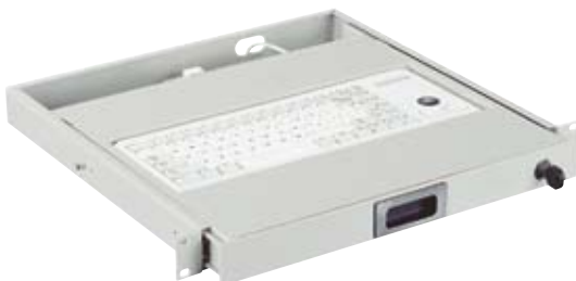
Szuflada 19" x 1 U z klawiaturą kompaktową z trackballem
