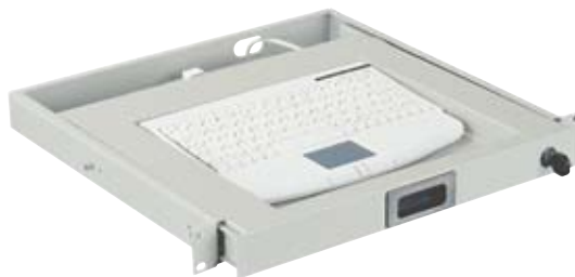
Szuflada 19" x 1 U z klawiaturą kompaktową z touchpadem
