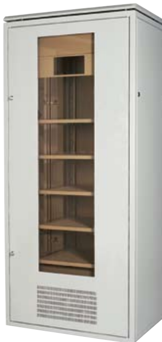
Szafa SZB o szerokości 800 mm z drzwiami przednimi blaszanymi z szybą z metapleksu i perforacją [5]
